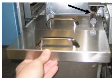
Rysunek 4: Umieść pokrywę na misce i przesunąć złączkę rury wlotowej oleju w żeńskie gniazdo ssące.
